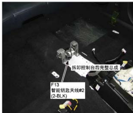
133. 底板控制台后部
